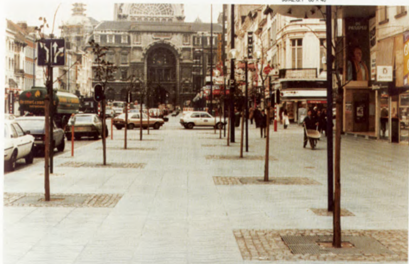
Ambers (Belgica). De Keyserlei. Arqto. Van Leemputten. Pavimento de Vibrazo Relieve en losas de 60 x 40.
